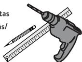
Utilizar una broca de 5/16" para hacer las perforaciones en el muro /
