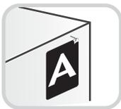
Al terminar de armar desprenda los adhesivos (en caso de que queden residuos de pegamento, limpie la superficie con alcohol) /
