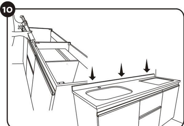
Se debe retirar el mesón antes de fijarlo con la silicona. Aplique silicona Anti-hongos por el contorno lateral y frontal del mueble como se muestra en la ilustración.
