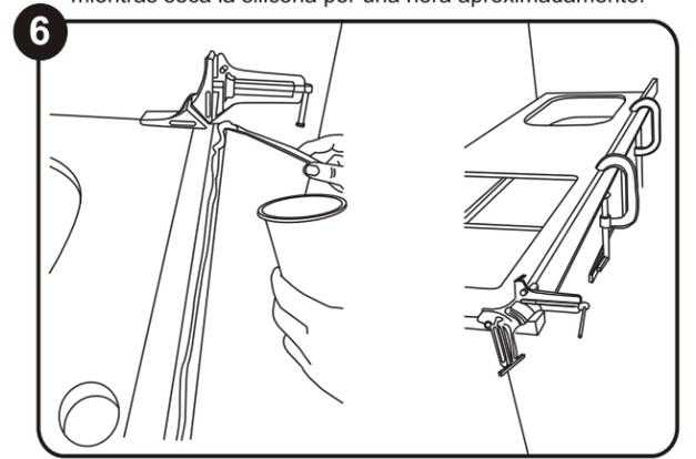
Proteja el piso antes de realizar la aplicación de la resina. Aplique un cordón de resina en el mesón justo tras la cinta de guía pegada previamente. Ubique el salpicadero en posición de uso y ajuste con las prensas manuales. No apriete en exceso podría quebrar el salpicadero.
