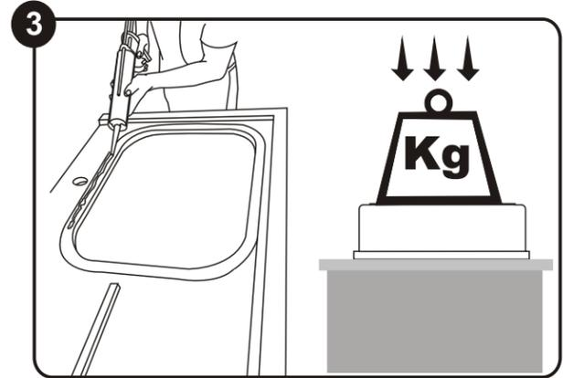
Después de trazar por el borde, retire el pozo y aplique un cordón de silicona anti-hongos uniforme de la línea demarcada hacia adentro del trazo previamente realizado.
