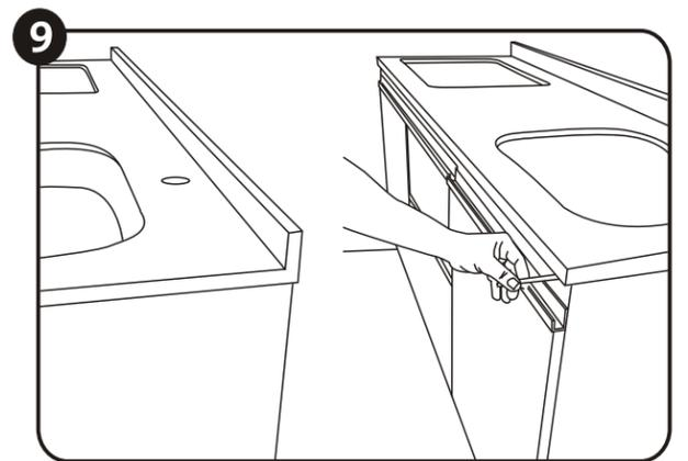
Revisar que en la parte de atrás el mesón debe quedar en el mismo perfil del mueble. En los laterales se debe guardar las mismas medidas en ambos lados, quedando el mesón debidamente centrado. La parte frontal debe quedar entre 1.5 a 2 cm sobresaliendo. Con un marcador borrable se traza por la parte inferior para demarcar donde debe quedar el mesón.
