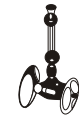
Shut-Off Valve and Flexible supply Tube Válvula de Cierre y Tubo Flexible de Suministro
